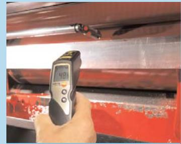
Надежность измерений благодаря лазерному целеуказателю
