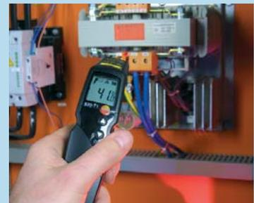
Измерительная точка диаметром 2 мм (testo 830-T3)
