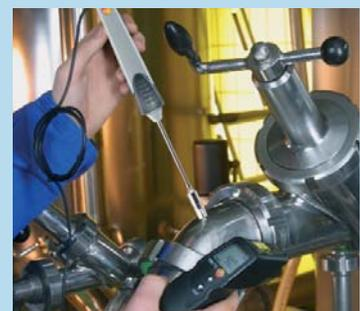
Подсоединение дополнительных зондов температуры (testo 830-T2/T3/T4;)
