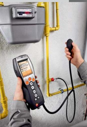
Проверка герметичности газовой трубы
