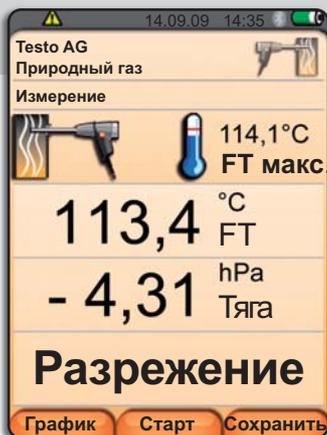
Результат измерения: наблюдается отрицательное давление (-4.31 гПа)
