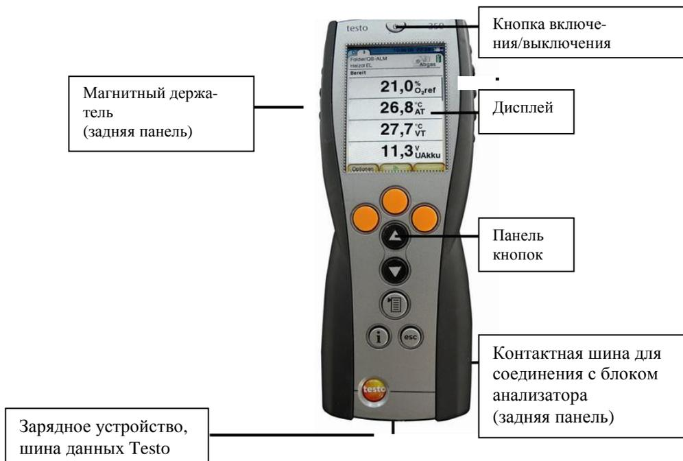
Рис. 2. Блок анализатора. Обзор
